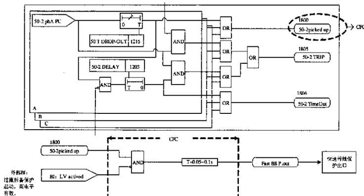
图 3 快速母线保护逻辑图 2
