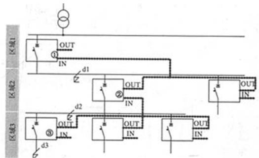
图 1 反向闭锁功能示意图
