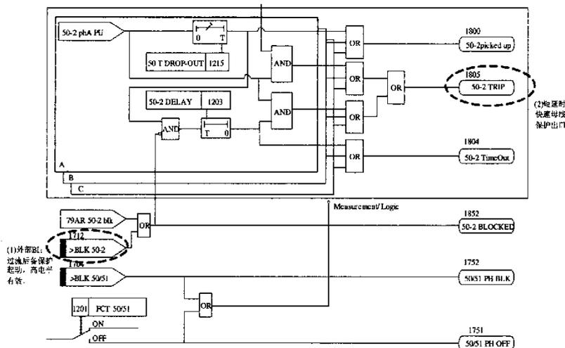
图 2 快速母线保护逻辑图 1
