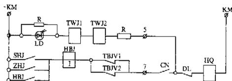
图 5 TWJ 直接接于合闸的开关辅助触点的回路图
